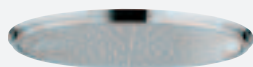
28 778 Soffione moderno Ø 400 mm getto largo normale a partire da 0,5 bar di pressione con sistema anticalcare SpeedClean raccordo a sfera con angolo di incli- nazione 20° + - 20° raccordo da 1/2"
