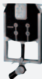
38 729 Uniset 80 mm telaio con cassetta per vaso sospeso spessore 80 mm telaio in acciaio zincato dimensioni 780 x 556 x 80 mm adatto per installazioni in pareti in muratura cassetta di sciacquo AV1 con 3 tipi di azionamento dual flush, start/stop e un solo sciacquo per piastre di piccole dimensioni verticali (156 x 197 mm) 38686, 37131 e 38558: eliminare codici e immagini
