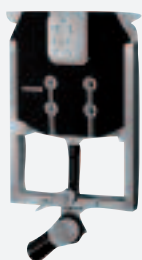
38 729 Uniset 80 mm telaio con cassetta per vaso sospeso spessore 80 mm telaio in acciaio zincato dimensioni 780 x 556 x 80 mm adatto per installazioni in pareti in muratura cassetta di sciacquo AV1 con 3 tipi di azionamento dual flush, start/stop e un solo sciacquo per piastre di piccole dimensioni verti- cali (156 x 197 mm)
