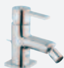
32 147 Allure miscelatore monocomando da 1/2" per bidet cartuccia a dischi ceramici da 28 mm bocca con mousseur orientabile con raccordi flessibili
