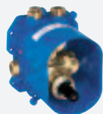
35 500 Rapido T corpo incasso termostatico universale per doccia, vasca doccia e centrale profondità di installazione 70 mm-90 mm cartuccia termostatica compatta terza uscita non intercettata
