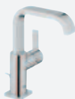
32 146 Allure miscelatore monocomando da 1/2" per lavabo cartuccia a dischi ceramici da 28 mm con raccordi flessibili limitatore di portata 6 l/m
