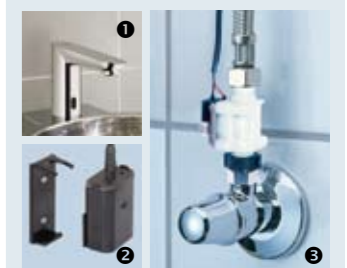
Euroeco cosmopolitan E 1 Robinet monofluide lavabo électronique infrarouge 2 Pile externe livrée dans un boîtier entièrement waterproof 3 Electrovanne externe, à monter directement sur l'arrivée d'eau 2 et 3 A monter sous le plan vasque
